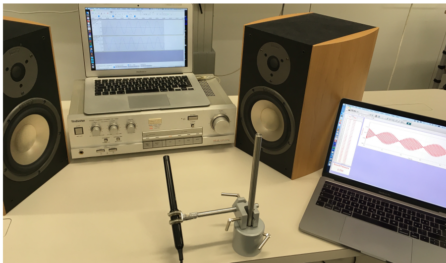
Abbildung 16: Das Versuchssetting zur Schwebungsmessung: Zwei Lautsprecher erzeugen je einen Sinuston. Das Mikrofon registriert die Überlagerung beider Wellen.
