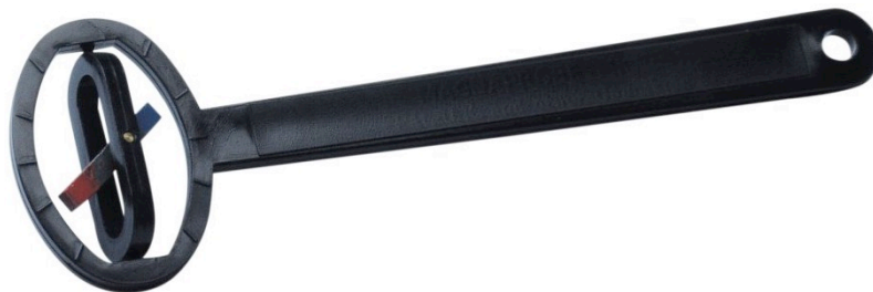
Abbildung 7.2: Die Magnaprobe – ein kleines, im dreidimensionalen Raum frei drehbares Stabmagnetchen. Dieser 3D-Mini-Kompass ist das richtige Instrument zur Ermittlung der Richtung eines Magnetfeldes!
