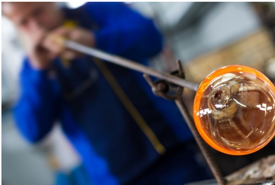
Abbildung 2.6: Das Glas wird bei einer Temperatur von ca. 1300\text{ °C} geblasen und in die gewünschte Form gebracht.
