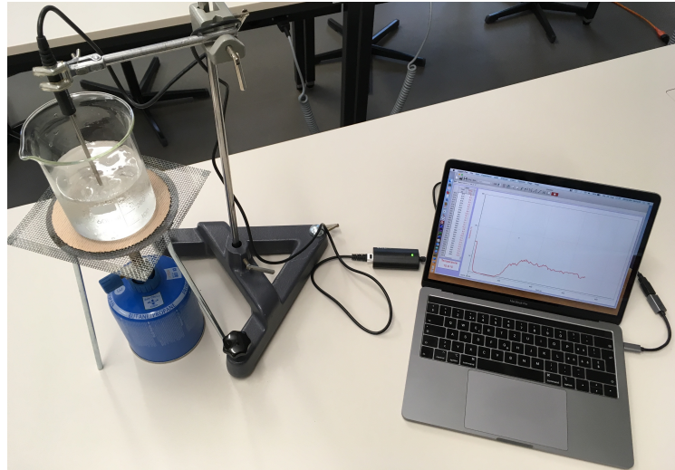
Abbildung 2.2: Erwärmung von Wasser: Die LabPro-Temperatursonde misst fortlaufend die Temperatur des Glasinhaltes.
