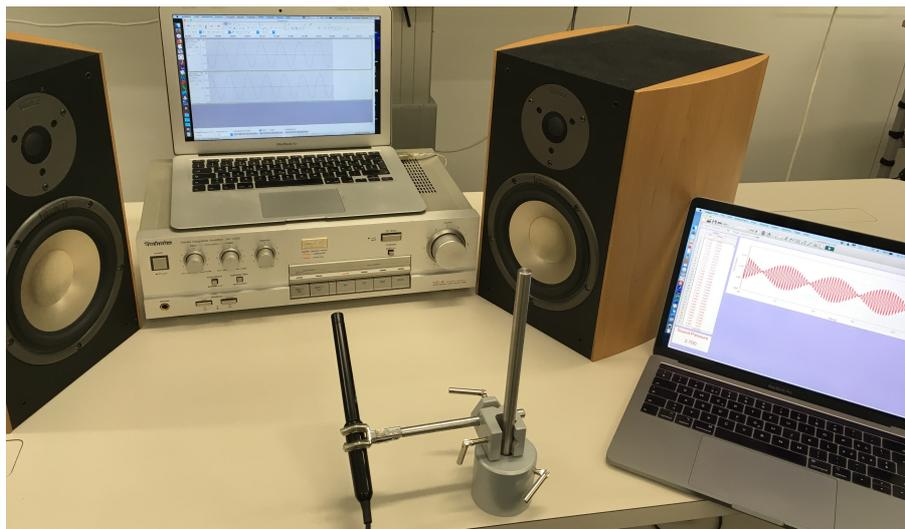
Abbildung 22: Das Versuchssetting zur Schwebungsmessung: Zwei Lautsprecher erzeugen je einen Sinuston. Das Mikrofon registriert die Überlagerung beider Wellen.
