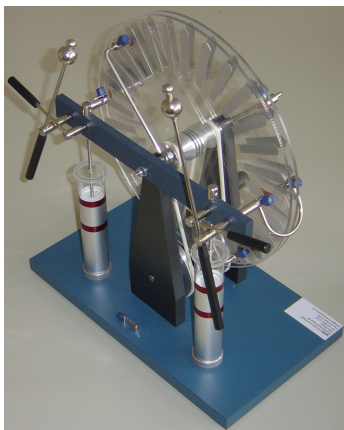
Abbildung 1.5: Influenzmaschine und Glimmlampe.
