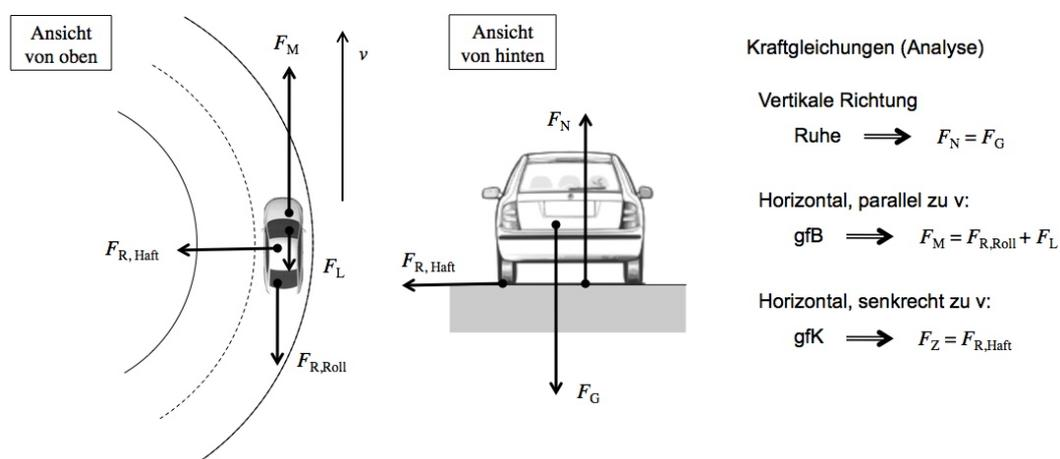
Die Strasse zieht das Auto durch die seitliche Haftreibung  $F_{R, \text{Haft}}$  mit den Pneus nach links. Dies sieht man im Bild, welches ein Rad von hinten zeigt.
