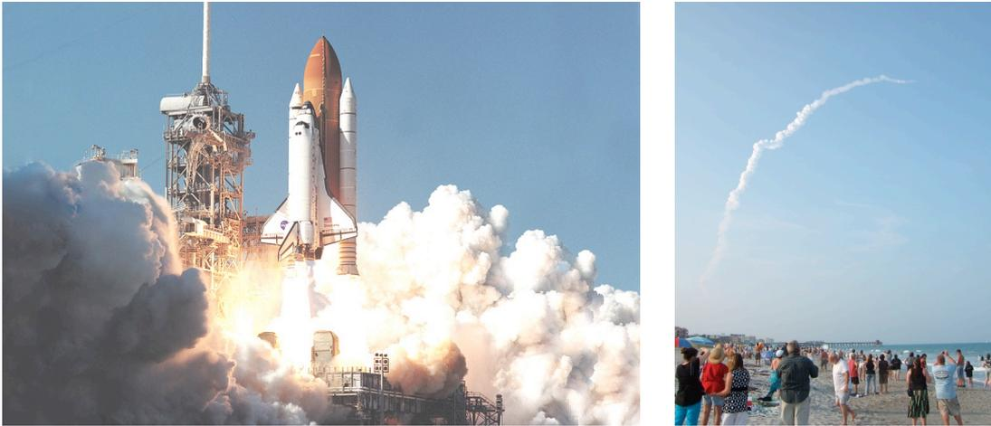
Inklusive der beiden seitlich angebrachten Feststoffraketen und dem grossen, vollen Treibstofftank besitzt das Space Shuttle eine Masse von etwa 2040 Tonnen. Beim Start (Bild links) erfährt es eine Beschleunigung von  $6.0 \frac{\text{m}}{\text{s}^2}$  in Aufwärtsrichtung.
