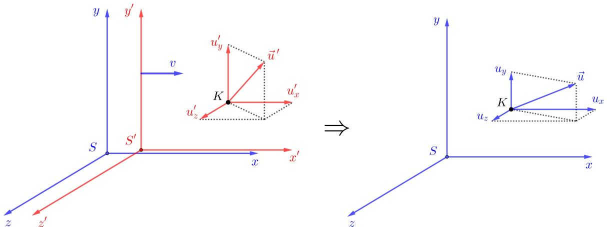
Offensichtlich muss die  $x$ -Komponente  $u_x$  der Geschwindigkeit  $\vec{u}$  im  $S$ -System eine andere sein als die  $x'$ -Komponente  $u'_x$  in  $S'$ , denn  $S'$  bewegt sich ja in  $S$  längs der  $x$ -Achse. Aber auch die Geschwindigkeitskomponenten in die anderen beiden Raumrichtungen müssen sich relativistisch gesehen verändern, denn die Zeit in  $S'$  vergeht anders als die Zeit in  $S$ . Unsere Fragestellung lautet somit:
