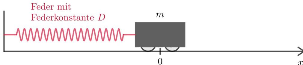
Wird der Wagen nach links oder nach rechts aus der Ruhelage ausgelenkt, so versucht ihn die Federkraft  $F_F$  in die Ruhelage  $x = 0$  zurück zu ziehen oder zu stossen. Es gilt:
