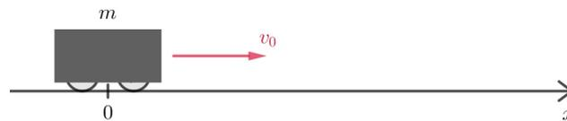
Stets soll die abbremsende Kraft  $F_B$  die einzige auf den Wagen wirkende Kraft sein, d.h.  $F_{\text{res}} = F_B$ . Da die Bewegung in die positive Richtung der  $x$ -Achse erfolgt, ist  $v_0 > 0$ .  $F_B$  wirkt dieser Bewegung entgegen, muss also als negative Kraft aufgefasst werden:  $F_B < 0$ .
