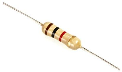
$\frac{1}{4}$ -Watt-Widerstände gibt es mit sehr kleinen oder auch extrem grossen Werten. Der aufgedruckte Farocode steht für den Widerstandswert. Zur Übersetzung dient uns die folgende Tabelle:
