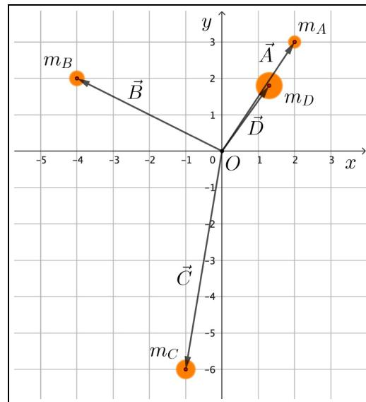
Wir sehen, wie die Masse  $m_D$  vor allem so platziert werden muss, dass sie die weite entfernte und einigermassen grosse Masse  $m_C$  kompensieren und den Schwerpunkt in den Ursprung bringen kann.
