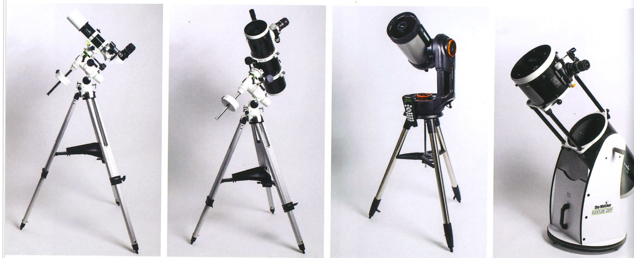
Von links nach rechts: die vier typischen Teleskoptypen Refraktor (Linsenteleskop), Newton (Spiegelteleskop), SCT (Spiegelteleskop mit Korrekturlinse) und Dobson (Newton-Spiegelteleskop).
