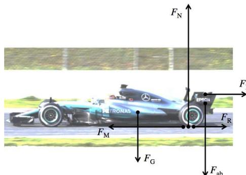
Die Motorenkraft muss bei gleichförmiger Bewegung Rollreibung und Luftwiderstand kompensieren. Spoiler vergrössern diese beiden Kräfte! (0.5 Punkte)
