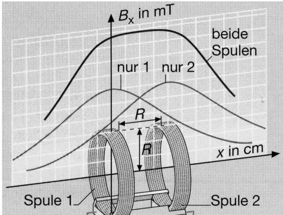
Abbildung 8.4: Bei einem Helmholtz-Spulenpaar werden zwei Spulenringe mit Radius  $R$  in eben diesem Abstand  $R$  voneinander parallel angeordnet.
