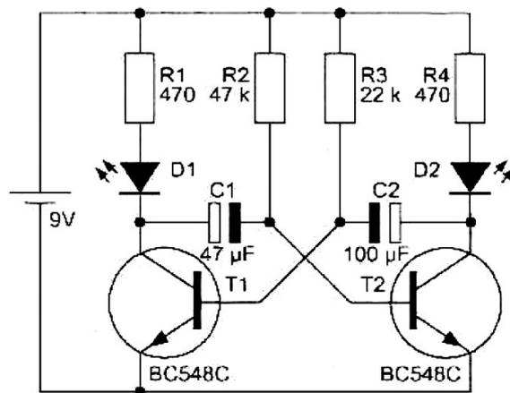
Abbildung 1.3: Eine Blinkerschaltung: Die beiden LEDs D1 und D2 leuchten abwechslungsweise auf. Zur Steuerung bedarf es weiterer Schaltelemente wie Kondensatoren (C1 und C2) und Transistoren (T1 und T2). In vielen Schaltschemata sind die Schaltelemente direkt mit näheren Spezifikationen angeschrieben. Hier handelt es sich z.B. um Transistoren des Typs BC548C.
