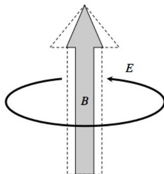
⇒ Das  $B$ -Feld gewinnt in Abwärtsrichtung an Stärke. Es wird ein entsprechend der Linken-Hand-Regel um das Magnetfeld **rotierendes**  $E$ -Feld erzeugt
