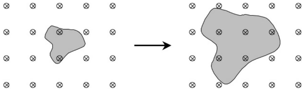
(b) Verstärkung des Magnetfeldes kann  $\Phi$  vergrößern:
