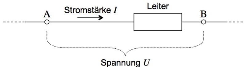
Abbildung 3.2: Illustration zur Idee des elektrischen Widerstandes: Aufgrund der über ihm angelegten Spannung  $U$  lässt ein Leiter eine bestimmte Stromstärke  $I$  zu. Der Leiter besitzt einen "elektrischen Widerstand", der bestimmt, wie viel Strom bei welcher Spannung fließt.
