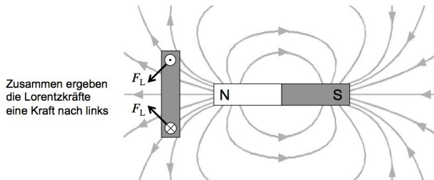
Abbildung 13.7: Die Abstossung des Rings erklärt durch Lorentzkraften, die der Induktionsstrom im  $B$ -Feld des Stabmagneten erfährt.
