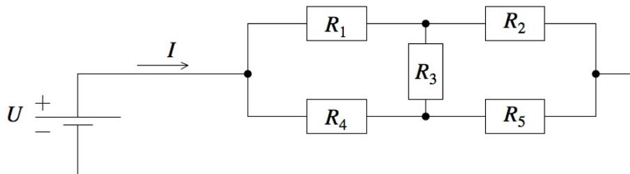
Abbildung B.1: Eine Schaltung, welche nur durch Anwendung der Kirchhoff'schen Regeln zu analysieren ist.
