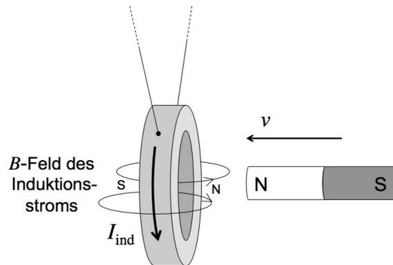
Abbildung 13.6: Der Induktionsstrom im Ring ist selber Quelle eines dipolartigen  $B$ -Feldes, dessen Richtung mit der RHR (Oersted'sche Regel) bestimmt werden kann. Der Ring ist damit ein Magnet mit einem Nordpol rechts, der sich vom Nordpol des Stabmagneten abstösst.
