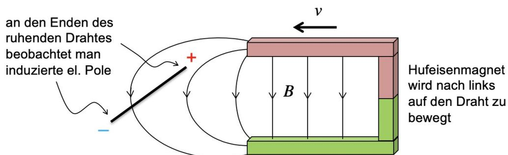
Abbildung 11.5: Im Laborsystem: Der Hufeisenmagnet wird von rechts auf den Draht zu bewegt. Wie soll sich diese Induktion durch Lorentzkräfte auf Leitungselektronen erklären lassen, wenn sich der Draht und damit auch die Leitungselektronen in ihm ja gar nicht bewegen?
