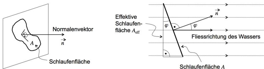
Abbildung G.2: Der Winkel  $\varphi$  zwischen der Fließrichtung des Wassers und dem Normalenvektor  $\vec{n}$  der Schleifenfläche bestimmt mit, wie viel Wasser pro Sekunde durch die Schleife fließt.
