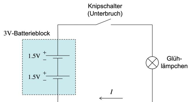
Abbildung 1.2: Der Taschenlampen-Stromkreis und das zugehörige Schalterschema.
