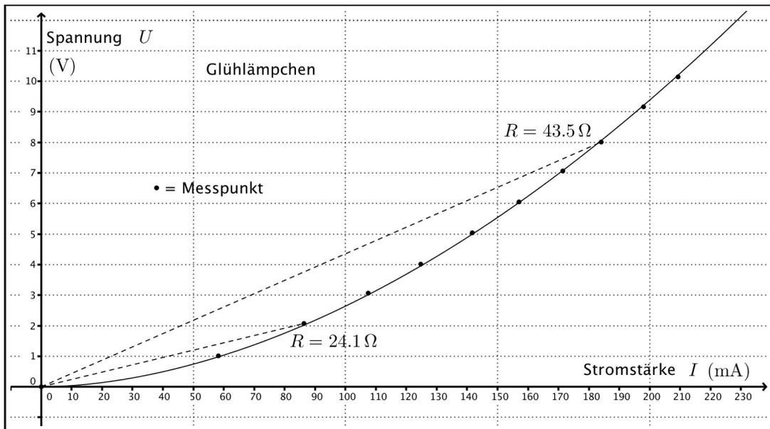
Abbildung 3.4: Kennlinie eines Glühlämpchens.
