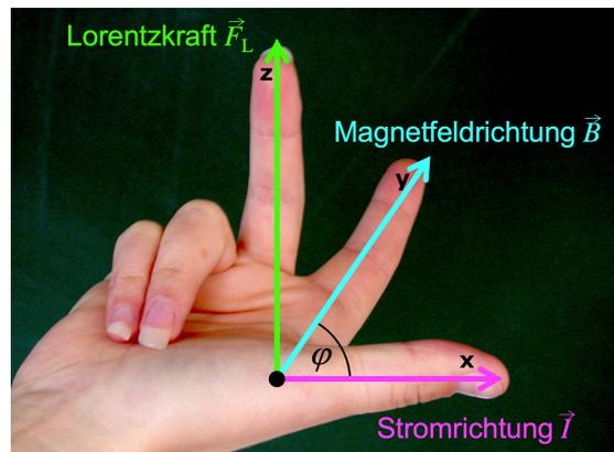
Abbildung 9.2: Die Lorentzkraft  $\vec{F}_L$  (Mittelfinger) steht stets senkrecht zur Stromrichtung  $\vec{I}$  (Daumen) und zur Richtung des Magnetfeldes  $\vec{B}$  (Zeigefinger). Die Vektoren  $\vec{I}$  und  $\vec{B}$  spannen eine Ebene auf, zu welcher die Lorentzkraft  $\vec{F}_L$  stets senkrecht steht.
