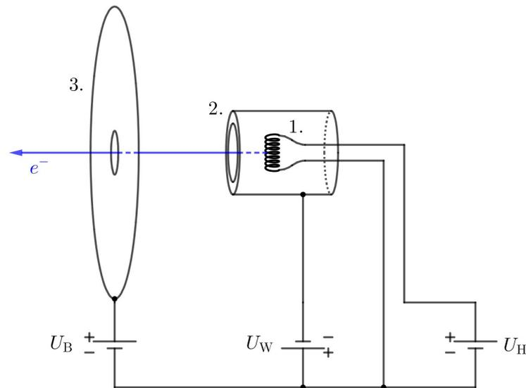
Abbildung E.1: Der schematische Aufbau einer Elektronenkanone.
