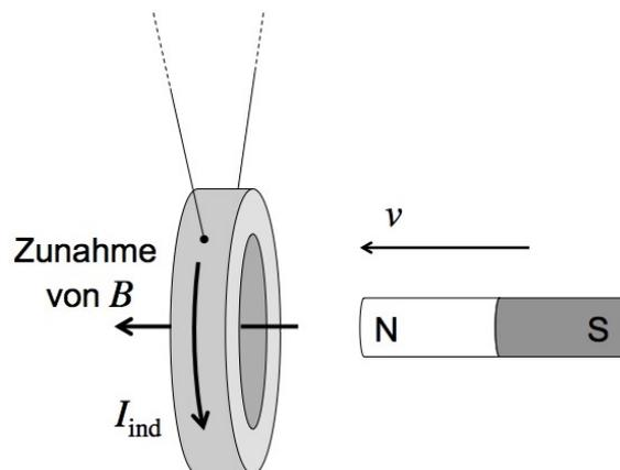
Abbildung 13.5: Durch das stärker werdende  $B$ -Feld wird im Ring ein Induktionsstrom hervorgerufen. Dieser fließt gemäss der LHR (Faraday'sches Gesetz) vom Stabmagneten aus gesehen im Gegenuhrzeigersinn.
