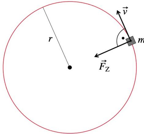
Abbildung 10.1: Bei gleichförmigen Kreisbewegungen nennt man die resultierende Kraft  $\vec{F}_{\text{res}}$  auch Zentripetalkraft  $\vec{F}_Z$ . Sie steht stets senkrecht zur momentanen Bewegungsrichtung  $\vec{v}$ .
