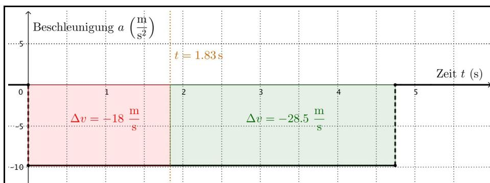
Die Diagramme sind "unphysikalisch": Abwurf und Landung können so real unmöglich stattfinden. Das sieht man bereits am Graphen im  $t$ - $s$ -Diagramm, wo wir an diesen Stellen einen "Knick" antreffen. Im  $t$ - $v$ -Diagramm werden daraus Sprünge. D.h., es sind Zeitpunkte, bei welchen sich die Geschwindigkeit scheinbar schlagartig verändert. Das kann so nicht sein. Tatsächlich bräuchte es an diesen Stellen kurze Beschleunigungs- resp. und Bremsphasen.
