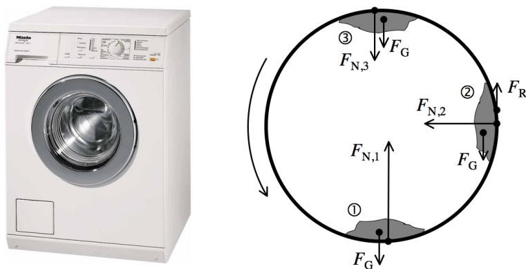
**Folgerungen:** In jedem der drei Momente erfährt der Wäscheklumpen total die gleich grosse Zentripetalkraft  $F_Z$  (= resultierende Kraft) in Richtung Trommelmitte, denn es handelt sich ja um eine gfK mit fixem Radius und fixer Geschwindigkeit.
